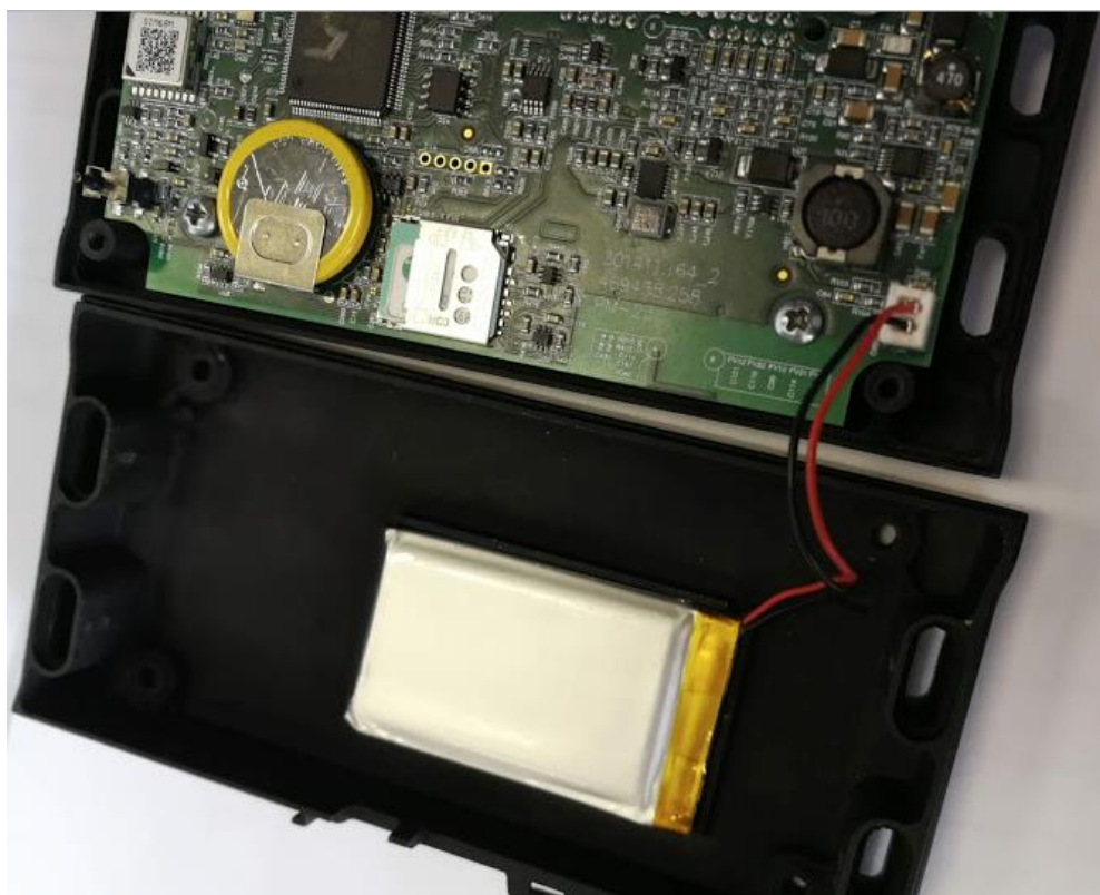
Рисунок 4.3. Подключение аккумуляторной батареи
