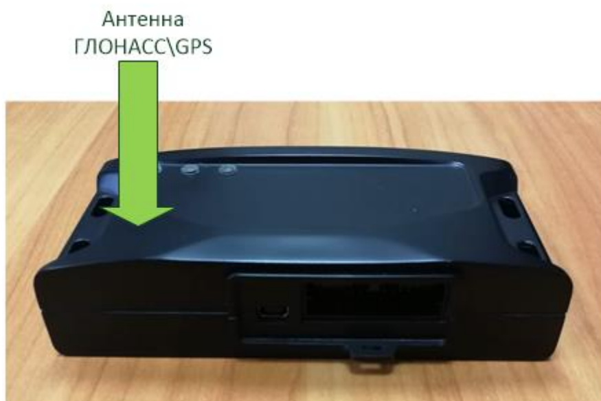
Рисунок 4.5. Ориентация FORT-114S при установке в транспортном средстве
