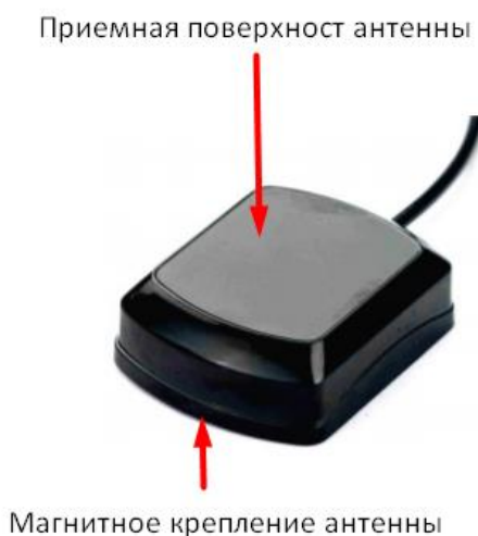
Рисунок 4.6 (б) Внешняя ГНСС (ГЛОНАСС/GPS) антенна
